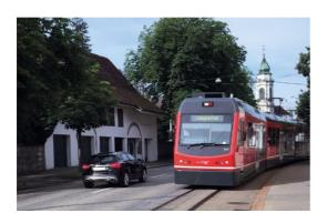
Abbildung 2: Bestehende Engstelle St. Josef; Gefährliche Platzverhältnisse beim Kreuzen von Bahn und Autoverkehr – Auto weicht auf Gegenfahrbahn aus.
