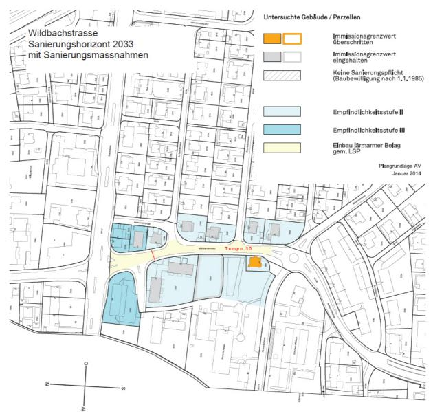
Abbildung 7: Situation LSP, Sanierungshorizont 2033 mit Sanierungsmassnahmen (Anhang H, Lärmsanierungsprojekt LSP, Solothurn, Wildbachstrasse)
