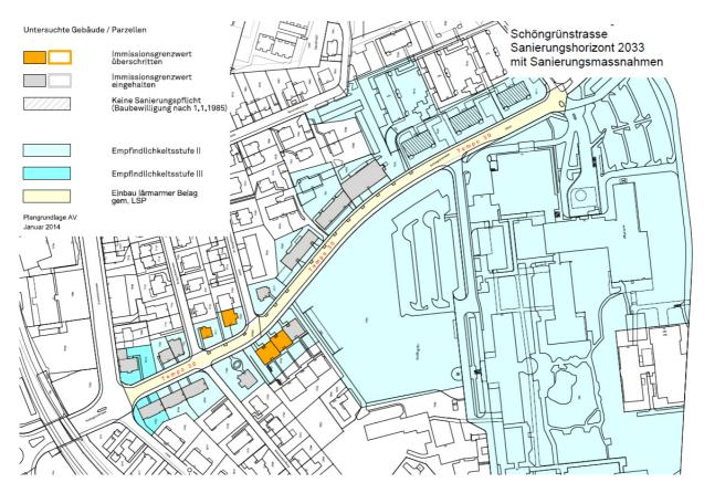
Abbildung 3: Situation LSP, Sanierungshorizont 2033 mit Sanierungsmassnahmen (Anhang H, Lärmsanierungsprojekt LSP, Solothurn, Schöngrünstrasse)
