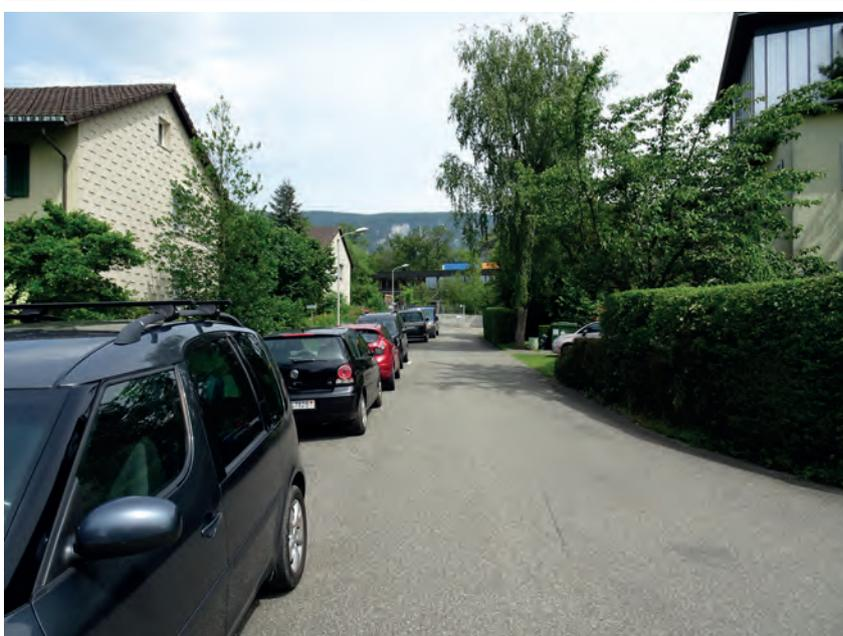
Im Beispiel der Ausfahrt aus der Amanz Gressly-Strasse in die Dürrbachstrasse würde die Begegnungszone zu einer konformen Situation führen. Die Hecke rechts im Bild schränkt die für eine Tempo 30 Zone erforderliche Sichtweite ein. Bei einer Höchstgeschwindigkeit von 20km/h wäre die vorhandene Sicht konform für den Rechtsvortrittsknoten.
