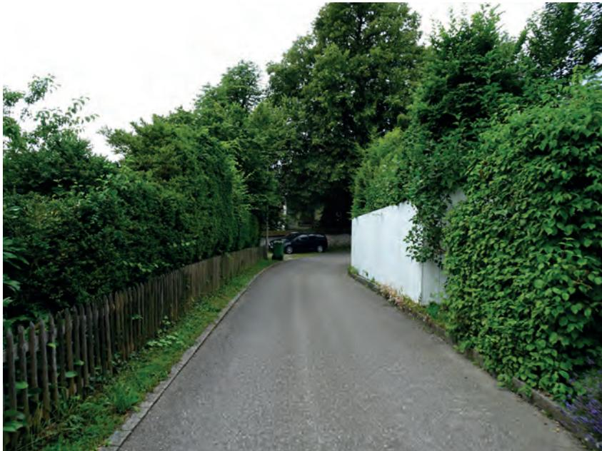
Im extremen Beispiel des Sälrains zeigt sich, dass die Begegnungszone selbst die Sichtverhältnisse nicht verbessert, durch die tieferen (vorgeschriebenen) Geschwindigkeiten jedoch die Sicherheit erhöht. Die Anforderungen an die Anhaltesichtweite um die Kurve senken sich, wenn langsamer gefahren wird.
