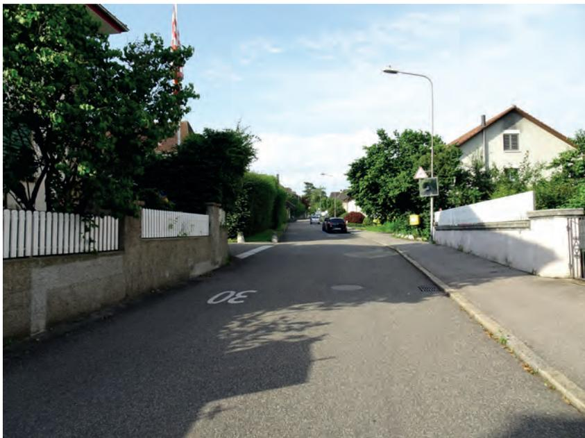
Bei der Einmündung der Burgunderstrasse in die Alte Bernstrasse ist heute in der Tempo 30 Zone ein STOP markiert. Die Sicht um die Ecke ist durch die Mauer derart eingeschränkt, dass dieser STOP auch bei der Signalisation einer Begegnungszone nicht aufgehoben werden kann. Die tiefere Geschwindigkeit reduziert jedoch die Gefährdung.
