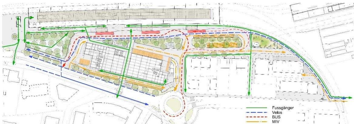
Abbildung 7; Übersicht Situation Bahnhofplatz Süd, verkehrliche Neuorganisation des Platzes, Ebene Erdgeschoss
