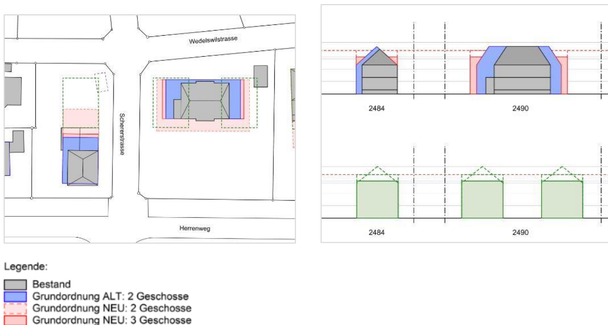
Abbildung 34: Ausschnitt Überprüfungen der Integration von Ersatzneubauten in einer Zone W3a (in grün: Variante neu mit mehreren Volumen, nach neuer Zonierung)
