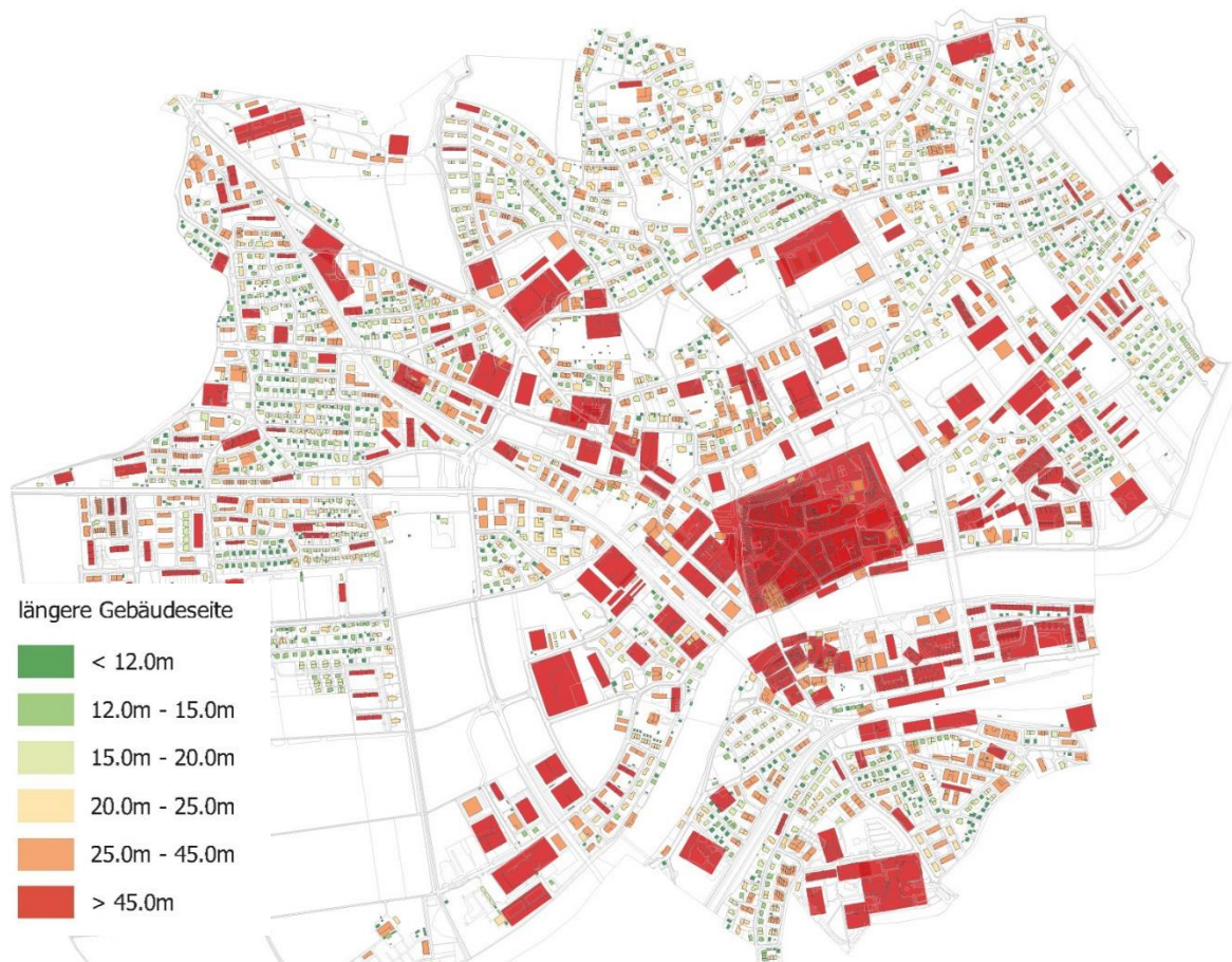
Abbildung 94: Überblick über die Gebäudelängen
