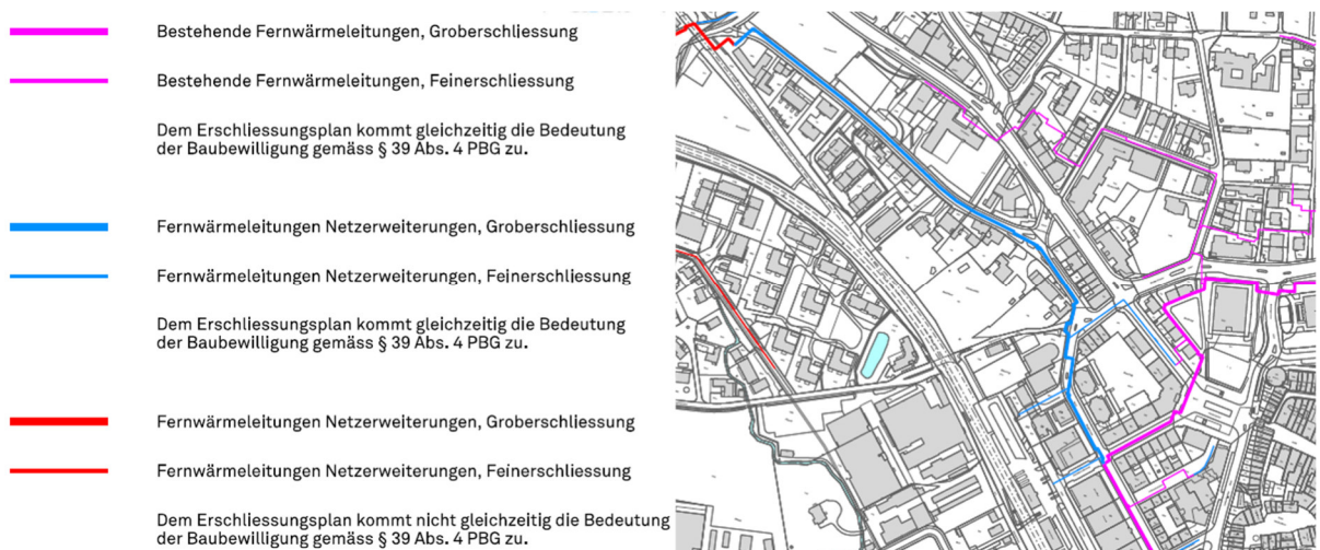
Abbildung 2: Ausschnitt aus dem rechtskräftigen Erschliessungsplan Fernwärme 2021
