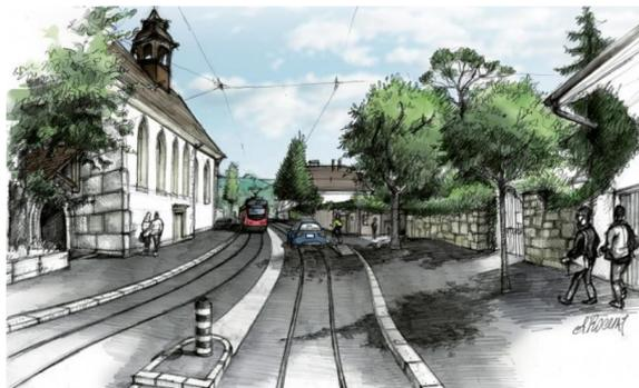
Abbildung 3: Neue Spuraufteilung Engstelle St. Josef; Neben den kombinierten Fahrbahnen für Autos und Bahn bleibt trotz des engen Strassenraumes neu genügend Platz für beidseitige Velo- und Fussgängerwege.
