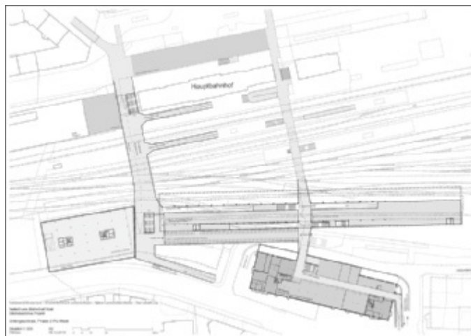
Plan Untergeschoss Perimeter Hauptbahnhof, mit geplanter neuer Personen- und Fahrradunterführung zwischen der heutigen Veloparkierungsanlage und dem zukünftigen Bahnhofplatz Süd, inklusive Zugang zum neuen Bahnhof RBS. Stand Dezember 2019
